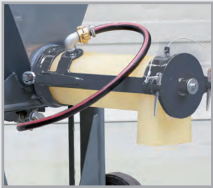
Резиновый шланг для быстрой очистки смесителя
